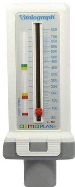
Débitmètre de mesure mécanique de DEP. Peut mesurer l'intensité d'une crise d'asthme et révéler un déficit respiratoire. Plage de mesure 50-800L/min. Avec marqueur de zone réglable (vert-jaune-rouge).
